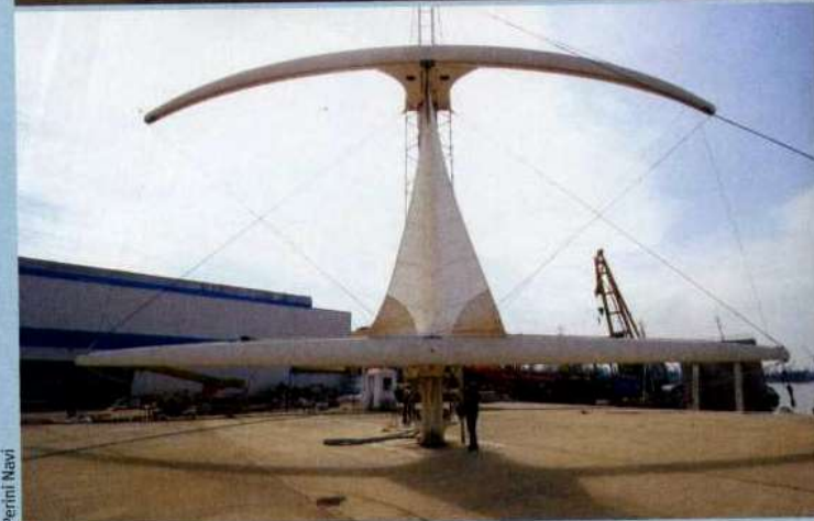
Sopra e in alto, ecco come si avvolgono le vele quadre all'interno dell'albero del Maltese Falcon. Un sistema computerizzato controlla contemporaneamente le quattro bugne con quattro winch.
